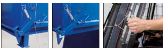
Der Kippmechanismus wird vom Fahrersitz bedient.
